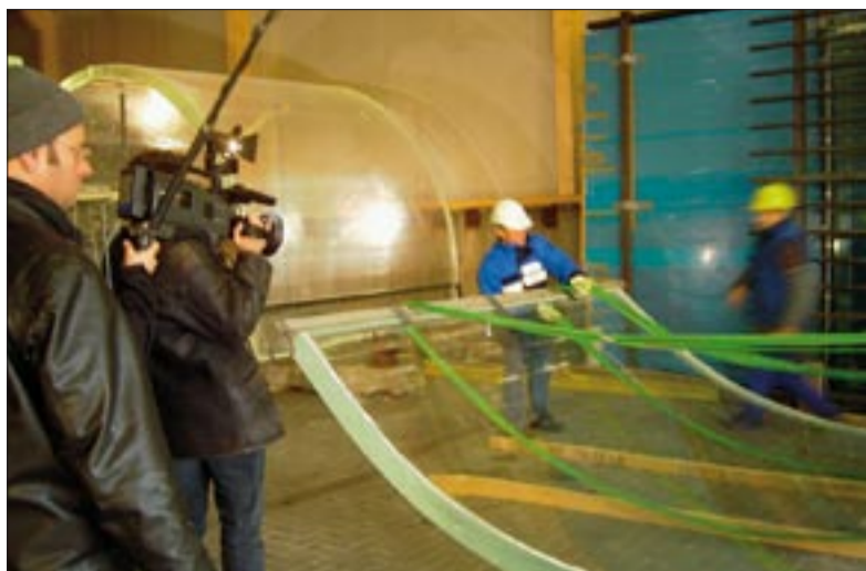
Stampare, incollare e poi giù in acqua. La Biacryl di Halle fa in modo che i giganteschi blocchi di PLEXIGLAS® realizzino un tunnel dalla volta uniforme. Solo allora potranno mettersi in viaggio per lo zoo di Gelsenkirchen, verso leoni marini e bambini affascinati.
