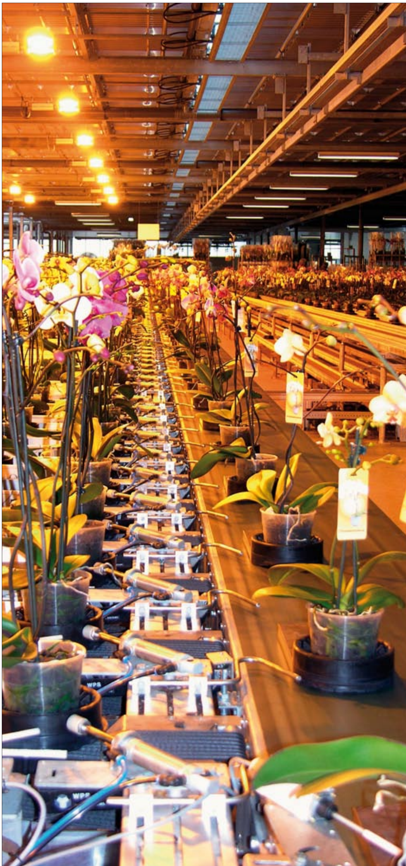
Qui tutto fila liscio come l'olio: le orchidee vanno alle stazioni di confezionamento completamente in automatico, su nastri trasportatori. La vita protetta nella serra è alle spalle: inizia il viaggio nel commercio floreale.
