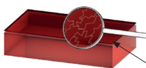
Plancha con capa protectora contra los rayos UV Prácticamente todo el espesor de material es sensible a los rayos UV Delgada capa protectora
