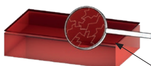
Plaque avec revêtement anti-UV La sensibilité au rayonnement UV est avérée sur toute l'épaisseur du matériau Fine couche de protection
