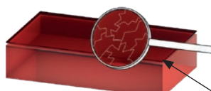
Lastra con strato di protezione UV Quasi l'intero spessore del materiale è sensibile agli UV
