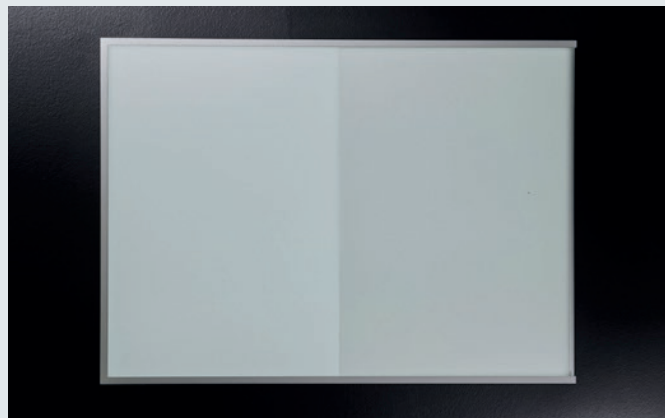
Abb. 2: Vergleich des Weiß-Tons bei Tageslicht (nicht hinterleuchtet) übliches, transluzentes weiß in der Lichtwerbung (rechts); PLEXIGLAS® LED Pure White WH52 (links)
