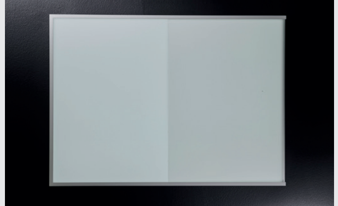
Figure 2 : Comparaison de la blancheur en lumière du jour (non rétro-éclairé) Blanc classique translucide en publicité lumineuse (à droite); PLEXIGLAS® LED Pure White WH52 (à gauche)
