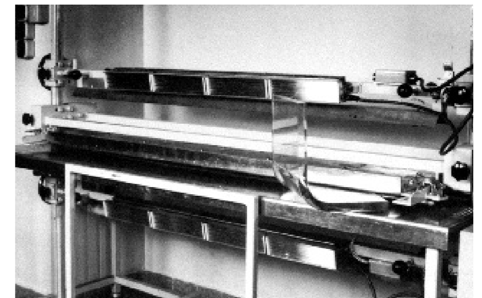
Abb. 6: Heizbank mit verschiedenen IR-Strahlern und abgekantetem Teil aus PLEXIGLAS®
